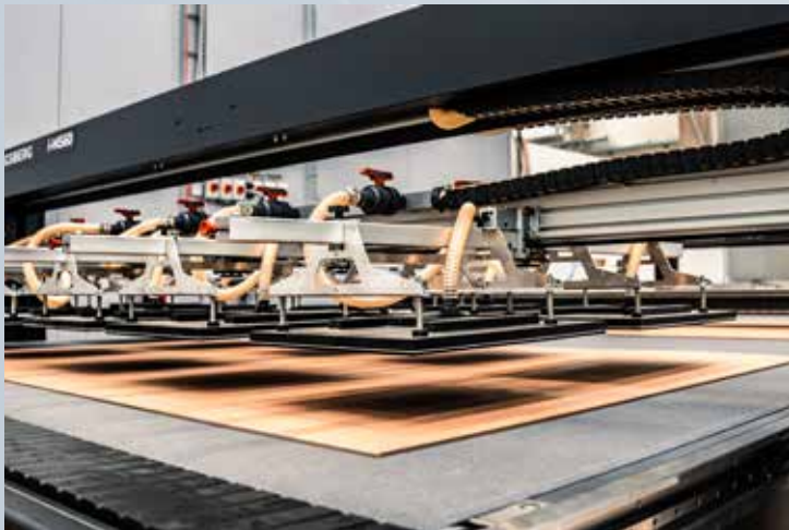
Automatische Materialförderung / Palletierung
